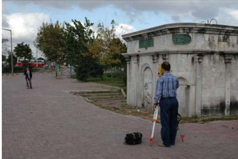
Şekil 4. Kontrol Noktaların Total Station ile ölçümü
